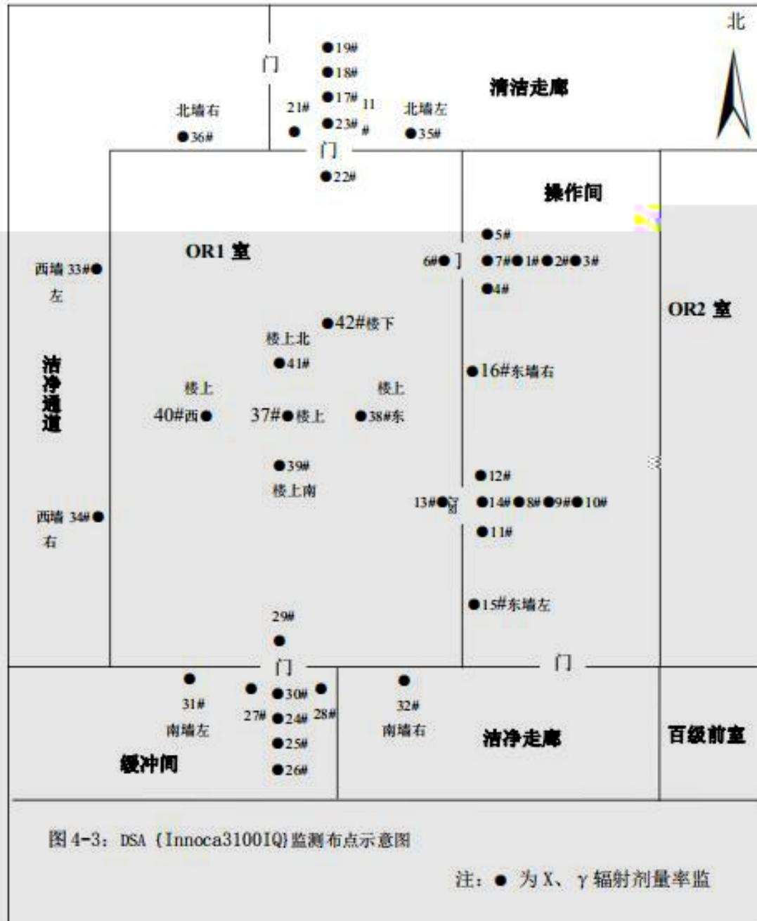
图 4-3： DSA (Innova3100IQ) 监测布点示意图
